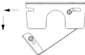
**1.** Der Kabelkanal kann entweder nach vorne zum Benutzer gerichtet oder nach hinten montiert werden.
