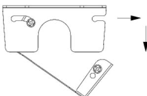
**2.** Nach dem der Kabelkanal an die Tischplatte montiert worden ist, lösen Sie bitte die seitlichen Schrauben M6x10 (4 Stck.) etwas für einen einfache Bedienung.
