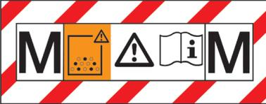
Sauger der Staubklasse M sind geeignet für das Auf-/Absaugen von trockenen, nicht brennbaren Stäuben, nicht brennbaren Flüssigkeiten, Holzstäuben und gefährlichen Stäuben mit AGWs  $\geq 0,1 \text{ mg/m}^3$ .
