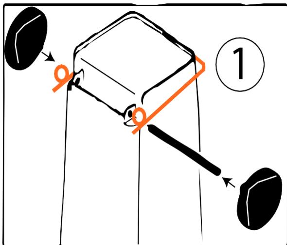
1. Schieben Sie ein Rad an einer Seite auf die Achse. Führen Sie nun die Achse durch eine Öse des Fußpedals sowie anschließend durch die Achsaufhängung des Behälters. Wiederholen Sie dies in umgekehrter Reihenfolge auf der anderen Seite des Behälters.
