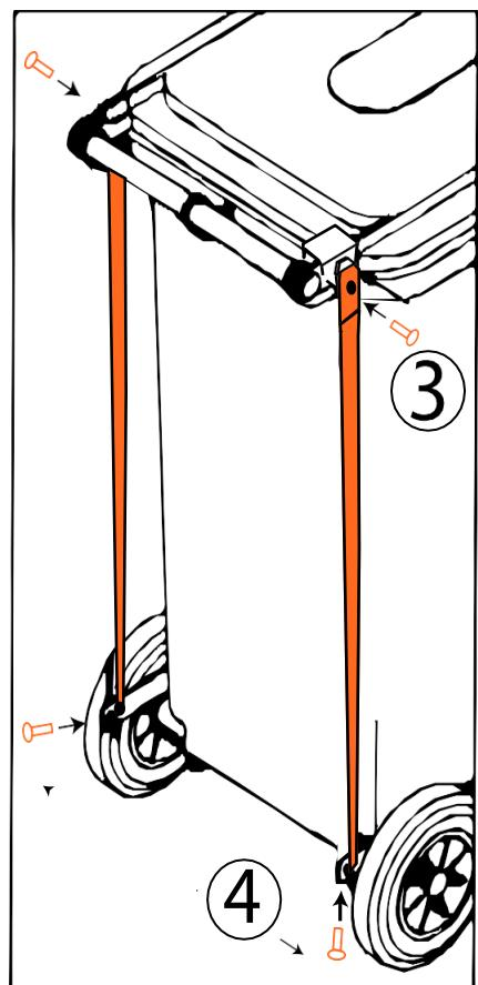
**Attention :** pour éviter de limiter le mouvement de l'ouvreur du couvercle, ne serrez pas trop les vis de fixation aux étapes 3-4
