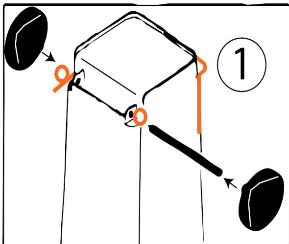
1. Poussez une roue sur l'essieu d'un côté. Faites maintenant passer l'axe par un œillet de la pédale et ensuite par la suspension de l'axe du conteneur. Répétez l'opération dans l'ordre inverse sur l'autre côté du récipient.
